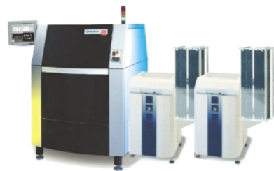
Bild 3: AOI mit nachgeschaltetem Smart Inline-AOI Sorter
